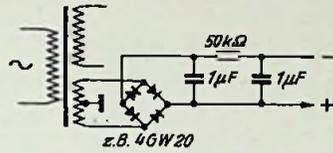
Bild 1. Erzeugung einer Vorspannung aus einer symmetrischen Heizspannung
