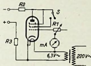
Bild 1. Schaltung eines Röhrenvoltmeters für große Gleichspannungen
