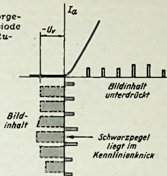
Praktisch verwendet man jedoch vorzugsweise Schaltungen mit gittergesteuerten Röhren zum Abtrennen der Impulse, weil sie hierdurch gleichzeitig verstärkt werden.
