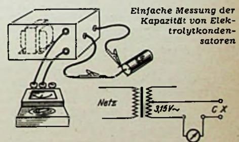
Die 6,3-V-Helzwicklung eines üblichen Netztransformators
