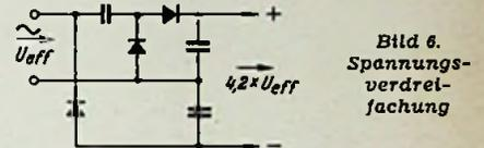
Bild 6. Spannungsverdreifachung
