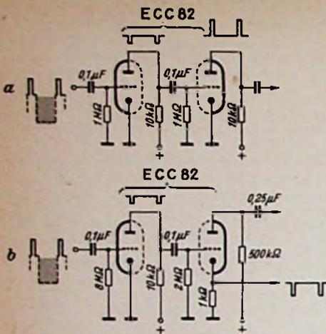
Bild 85. Amplitudensieb mit einer Doppelröhre ECC 82
