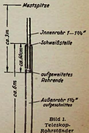
Bild 1. Teleskop-Rohrständer
