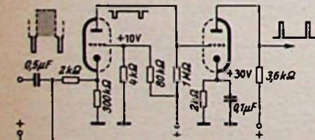
Bild 86. Negativ gerichtete Synchronisierimpulse werden der Katode der Impulsabtrennröhre zugeführt
