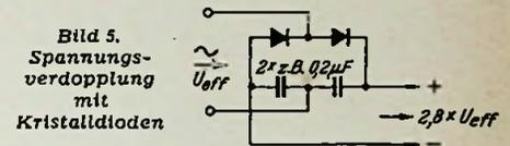
Bild 5. Spannungsverdopplung mit Kristalldioden
