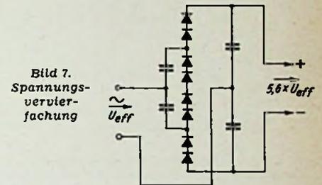
Bild 7. Spannungsvervierfachung
