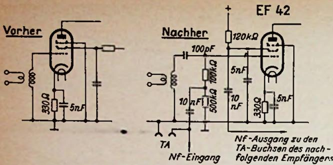
Ausnutzung der Vorröhre eines UKW-Pendlers zur Nf-Verstärkung. Die Nf-Spannung wird dem Steuergitter über einen 100-k $\Omega$ -Vorwiderstand zugeführt und verstärkt an einem Widerstand in der Schirmgitterleitung abgenommen. Wird der Klang zu dumpf, kann der Schirmgitterkondensator auf 500 pF verkleinert werden.
