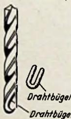
oder Kupferdraht die Nuten an der Bruchstelle zum Teil auffüllt (Bild). Der Bohrer läßt sich dann wieder fest im Spannfutter der Bohrmaschine befestigen. Ein auf diese Weise „ausgebesselter“ Spiralbohrer ist sogar manchmal vorteilhafter; wegen seiner geringeren Länge kann man beim Bohren einen größeren Druck ausüben, ohne daß er wieder abbricht. Dr. R. Ferenc
