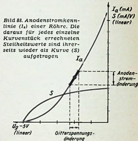
Bild 88. Anodenstromkennlinie ( $I_a$ ) einer Röhre. Die daraus für jedes einzelne Kurvenstück errechneten Steilheitswerte sind ihrerseits wieder als Kurve (S) aufgetragen
